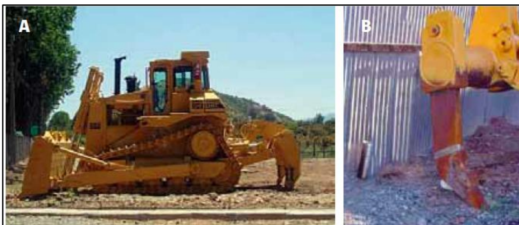
A) Bulldozer. B) Equipo subsolador.
