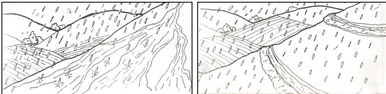
Imágenes de ladera de cerro frente a una lluvia sin curvas de esguerrimiento (izquierda) y con curva de esguerrimiento (derecha).
